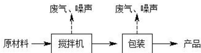
图3 粉末涂料生产工艺流程及产污节点图
