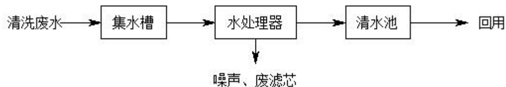
图4 水处理工艺流程及产污节点图
